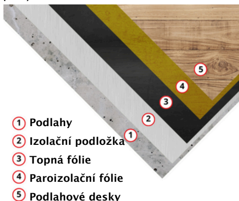
Obr.2 Vzor pokládky topných fólií pod podlahové panely
